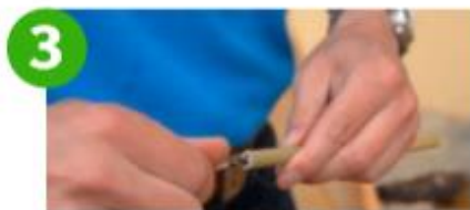
3 Mit den Bohrern eventuell vorhandene Tülle aus Bambusstangen entfernen
